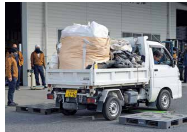
廃プラスチック類を地面に設置したセンサーで計量
