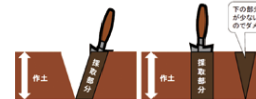
目的の部分までV字に掘り、採取するか、コテで垂直に柱状に採取する。土層の上部と下部の体積が同じくらいになるように注意する。
